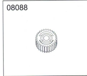
08088 One level output gear 30 teeth 一级输入齿30牙
