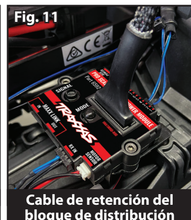
Conectores del sentido del motor
